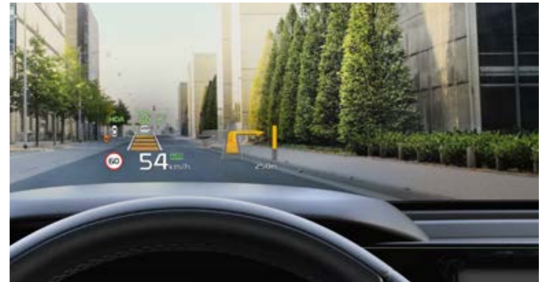
תצוגה עילית HUD* על מנת להבטיח תשומת לב מירבית לכביש, התצוגה העילית מקרינה נתונים כמו מהירות נסיעה והתראות ממערכות הבטיחות ישירות על השמשה הקדמית.
