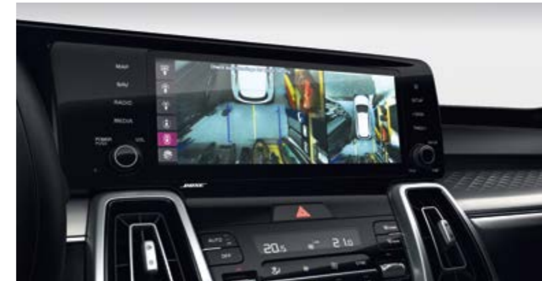
מצלמות היקפיות 360* מערכת המשלבת 4 מצלמות בעלות עדשה עם זווית רחבה הממוקמות בחלקו הקדמי, האחורי ומצדדי הרכב, ויוצרות "מבט על" על הסביבה של הסורנטו לסיוע בתמרוני חניה.
