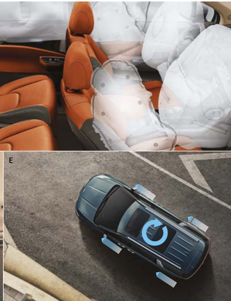
C. מערכת לשמירת מרכז נתיב (LFA) כדי לסייע בהגנה על הנוסעים ובהפחתה אפשרית של פגיעות במקרה של התנגשות, מוצעות בקרניבל שבע כריות אוויר (לנהג, לברכי הנהג, לנוסע קדמי, שתי כריות אוויר צדיות מלפנים ושתי כריות וילון צדיות).
