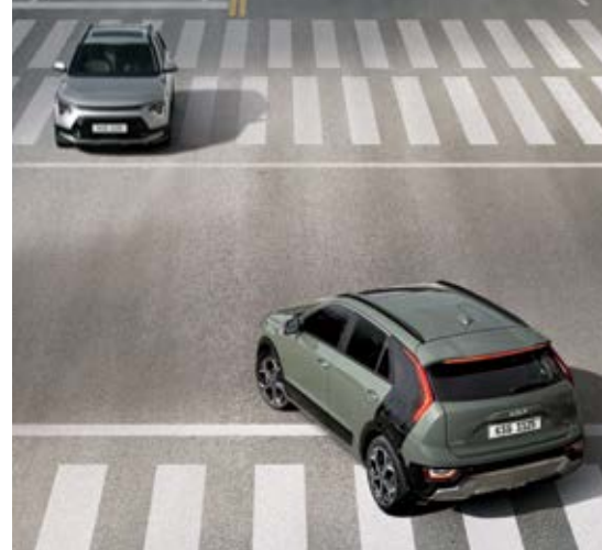
מערכת לסיוע במניעת התנגשות קדמית (FCA) באמצעות מצלמה קדמית ורדאר קדמי, מסוגלת מערכת FCA לזהות כלי רכב, הולך רגל או רוכב אופניים שנמצא לפניך, להזהיר אותך, ואפילו לבלום באופן אוטומטי. היא תבלום גם באופן אוטומטי אם היא מזהה סכנה של רכב שמתקרב מימין או משמאל בצומת שפניך.
