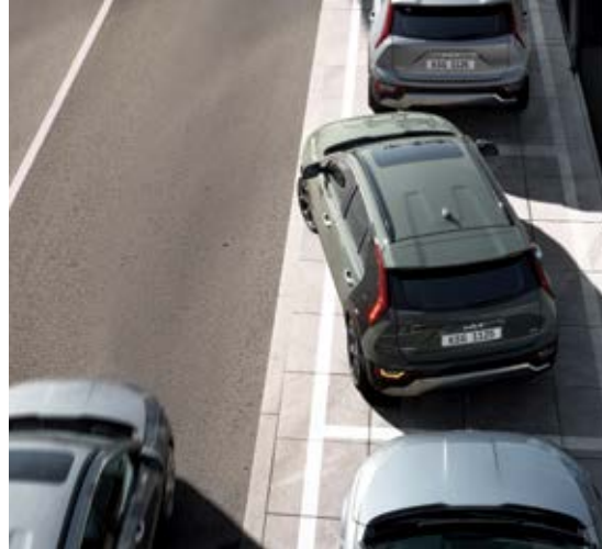
מערכת לסיוע במניעת התנגשות בשטח מת (BCA) כשאתה מפעיל את מהבהבי הפנייה כדי לעבור נתיב, מערכת BCA מזהירה אותך אם קיימת סכנה של התנגשות עם רכב שמגיע מאחור. אם בעת יציאה מחניה במקביל קיימת סכנה של התנגשות עם רכב שנמצא מאחור, היא מסייעת באופן אוטומטי באמצעות בלימת חירום.
