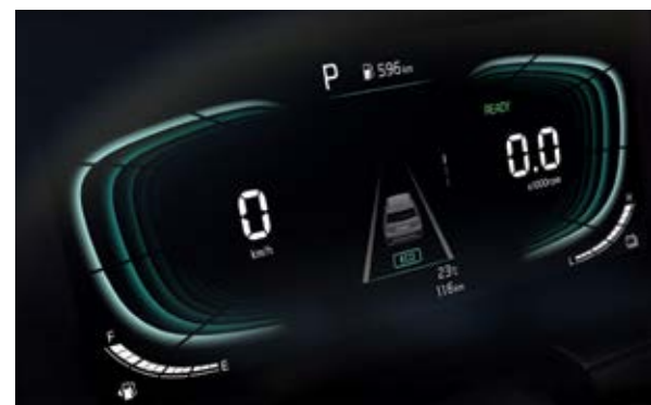
לוח מחוונים Supervision (צג 4.2 TFT LCD אינץ') בדגם פלאג אין
